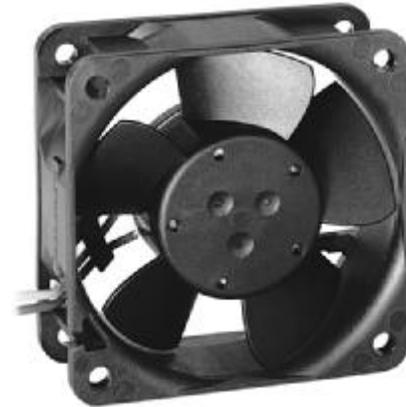
Sehr kompakter, 25 mm flacher Lüfter für Gleichspannungsbetrieb. Mit hervorragenden Luftleistungswerten bei geringem Betriebsgeräusch. Antrieb durch elektronisch kommutierten Außenläufermotor mit geringer Leistungsaufnahme. Die Kommutierungselektronik ist vollständig in die Lüfternabe integriert. (Abb. ähnlich)
